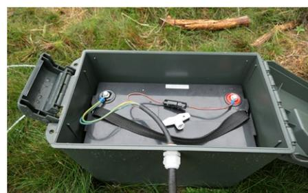
Die Bleibatterie passt exakt in eine wasserdichte Munitionskiste. Zur Verbindung mit der Box dient eine schwere Gummischlauchleitung.
