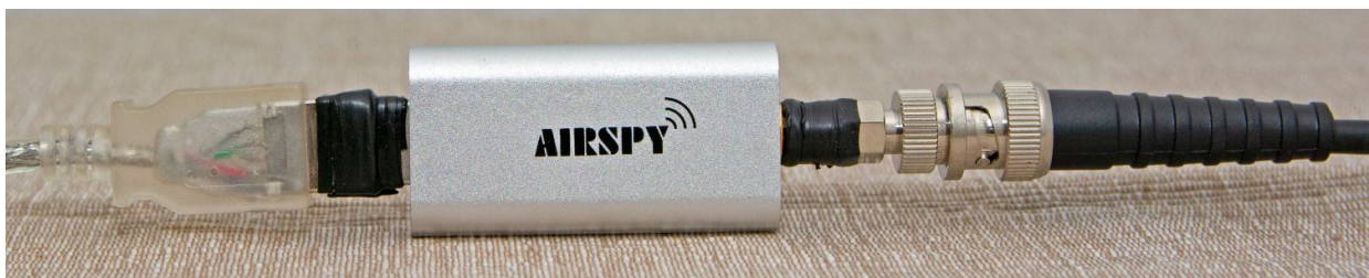
Airspy mini, die Verbindungen sind durch selbstverschweissendes Kautschukband gesichert.
